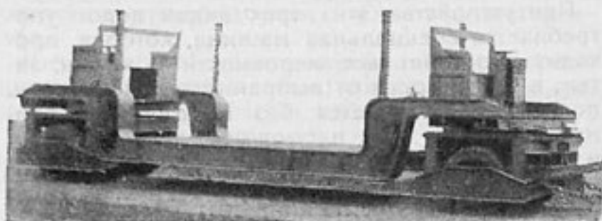
Низко-посаженная грузовая прицепка
